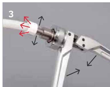
3 Расширение трубы (1). Выбрать расширительную насадку, соответствующую диаметру трубы и постепенно расширять трубу.
